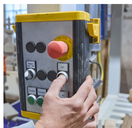
Oben: Die Fernbedienung beschleunigt das Positionieren der Säge.
