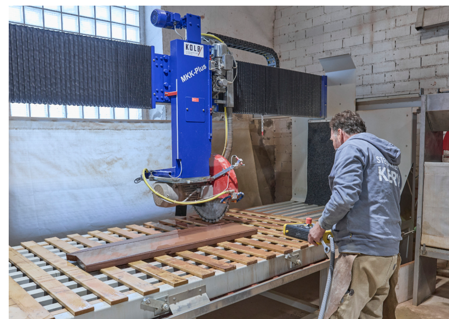
Oben: Die Fernbedienung beschleunigt das Positionieren der Säge.
