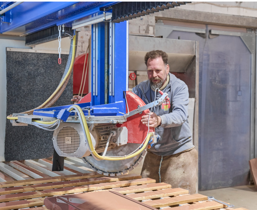
Oben: Der Sägekopf lässt sich manuell um 90 Grad schwenken.
